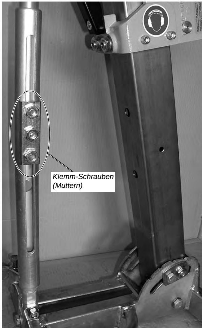
Optionale Bohrsäulenstütze (570 mm) an der P-6000 Bohrsäule Bild 3.10
