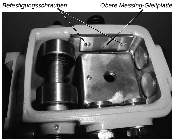
P6000-Führungsschlitten auf der Bohrsäule über die Zahnstange hinaus gefahren (Blick von oben) Bild 7.7
