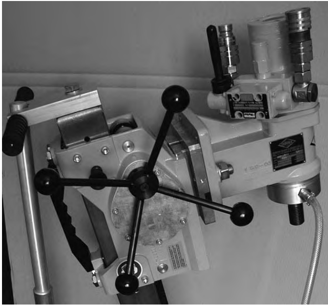
Hydraulikmotor HM-161 mit BSP-3 an der Anbauplatte für die BSP-3 am P-6000 Führungsschlitten montiert Bild 3.41
