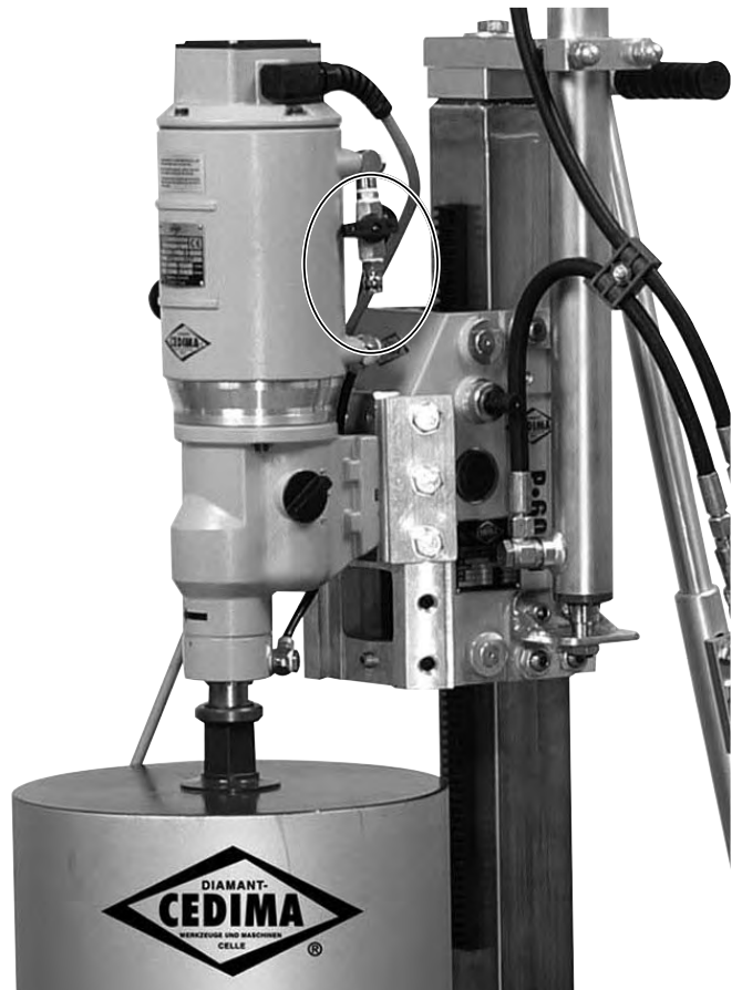
Wasseranschluß am EM-3/7 (mit Bohrkronen)
