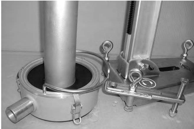
Wassersammelring mit Wassersammelring-Halter an Bohrkronen ausgerichtet Bild 3.52
