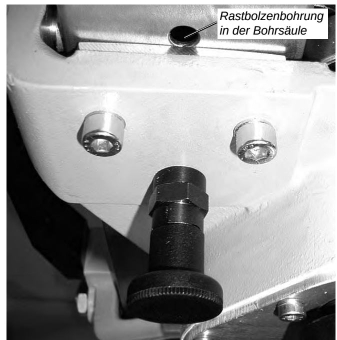
P-6000 Führungsschlitten-Rastbolzen eingerastet (Führungsschlitten festgesetzt)
