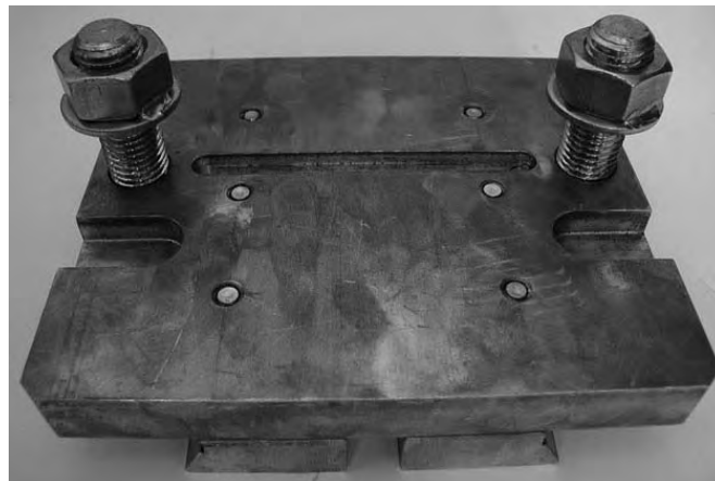
Anbauplate für Bohrspindel BSP-3 an P-6000 (Bestell-Nr. 4872)
