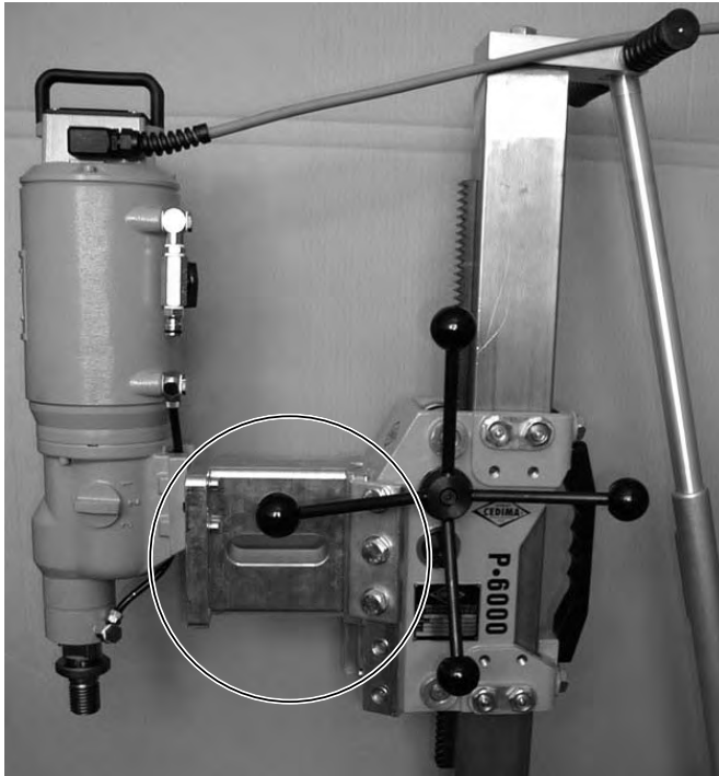
Bohrmotor (EM-3/7) mit (170 mm) Anbauplatte K am P-6000 Führungsschlitten montiert
