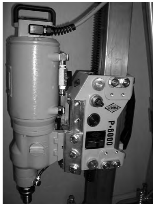
Bohrmotor (EM-3/7) in tiefer Position am P-6000 Führungsschlitten montiert
