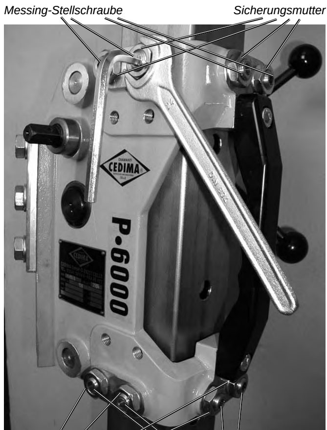
Einstellbare Gleitführungen (Messing-Stellschrauben) am P-6000-Führungsschlitten (rechts Verschleißgrenze erreicht)
