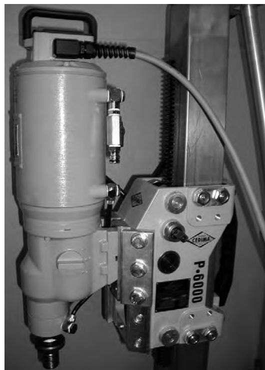
Bohrmotor (EM-3/7) in hoher Position am P-6000 Führungsschlitten montiert
