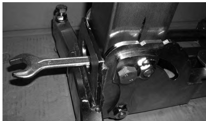
SW-24 Gabelschlüssel (mitgeliefert) in P-6000 Dübelfuß-Öffnung gesteckt Bild 3.15
