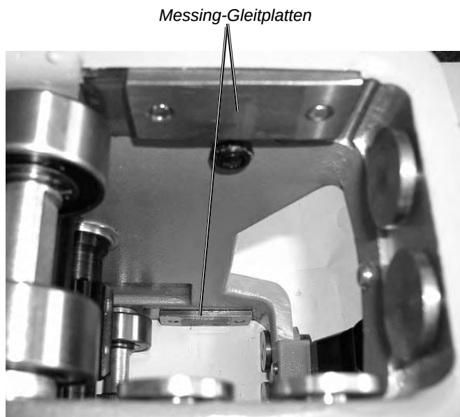
P-6000-Führungsschlitten demontiert (Blick von oben) Bild 7.8
