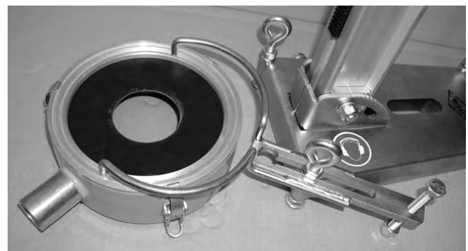
Wassersammelring mit Wassersammelring-Halter Bild 3.51
