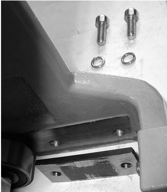
P6000-Führungsschlitten demontiert. Untere Messing-Gleitplatte demontiert
