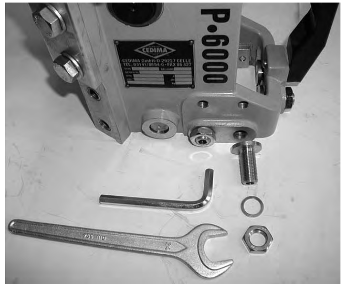
Einstellbare Gleitführung (Messing-Stellschraube mit Pass-Scheibe und Sicherungsmutter) vom P-6000-Führungsschlitten demontiert (Gabelschlüssel SW 24 und Innensechskantschlüssel SW 8)
