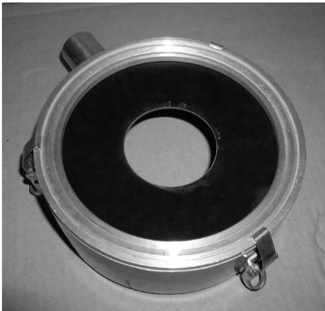
Wassersammelring mit eingelegter Dichtscheibe (für Ø 81 mm Bohrkronen) und aufgespanntem Deckel (-Ring) Bild 3.48
