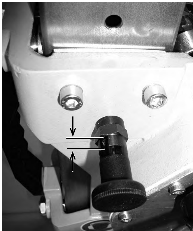
P-6000-Führungsschlitten-Rastbolzen außer Funktion gesetzt (Verfahrposition) Bild 3.7
