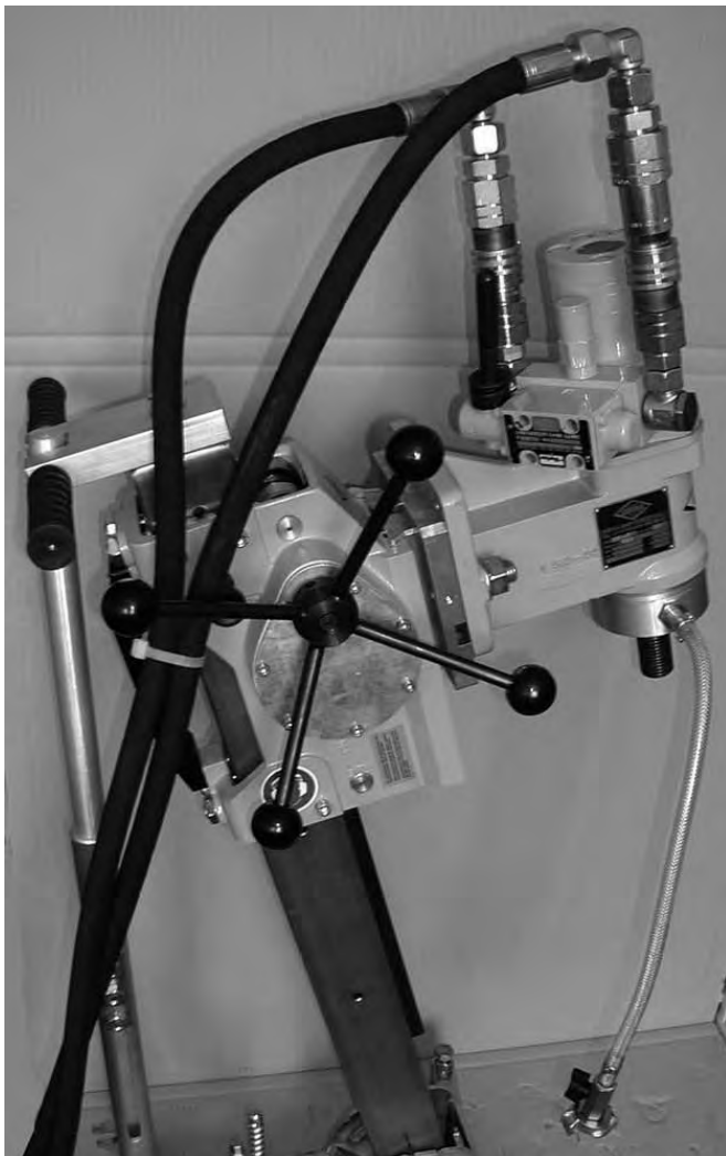
Hydraulikmotor HM-161 mit BSP-3 an der Anbauplatte für die BSP-3 am P-6000 Führungsschlitten montiert Bild 3.42
