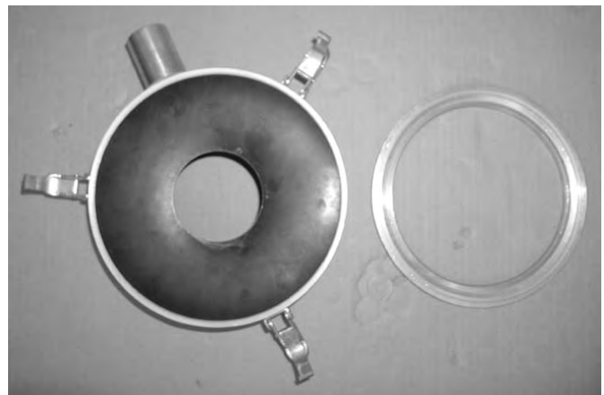
Optionale Dichtscheibe (für Ø 81 mm Bohrkronen) in Wassersammelring eingelegt
