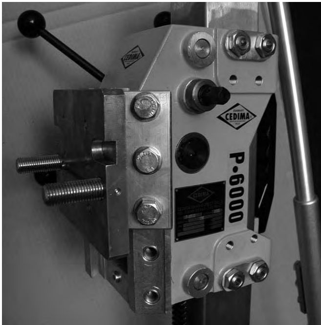
Anbauplatte für die Bohrspindel BSP-3 am P-6000 Führungsschlitten montiert
