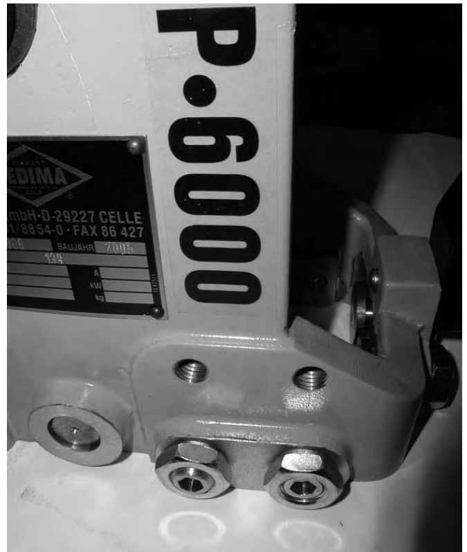
Einstellbare Gleitführungen (Messing-Stellschrauben) am P-6000-Führungsschlitten (rechts Verschleißgrenze erreicht)
