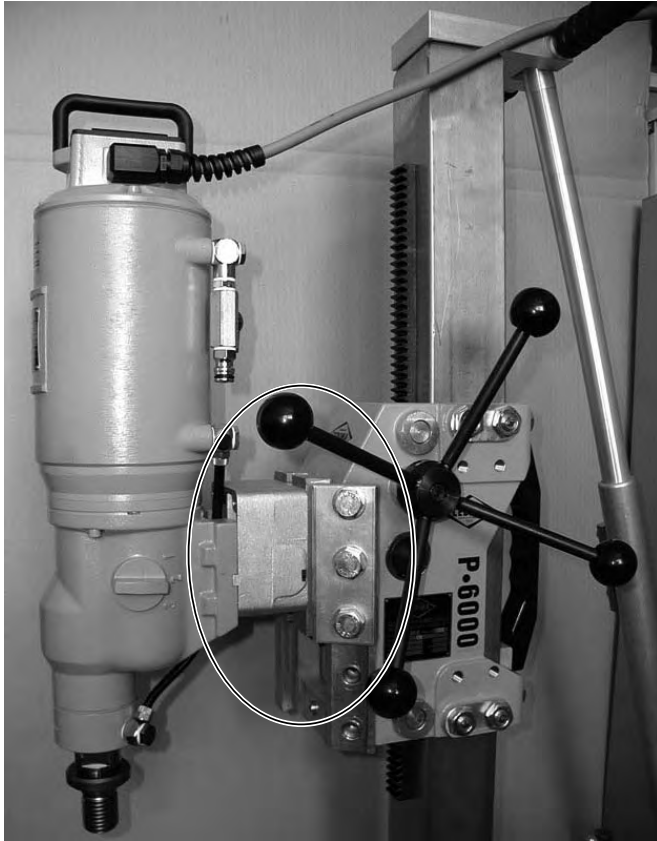
Bohrmotor (EM-3/7) mit (60 mm) Distanzplatte und Anbauplatte C am P-6000 Führungsschlitten montiert Bild 3.34
