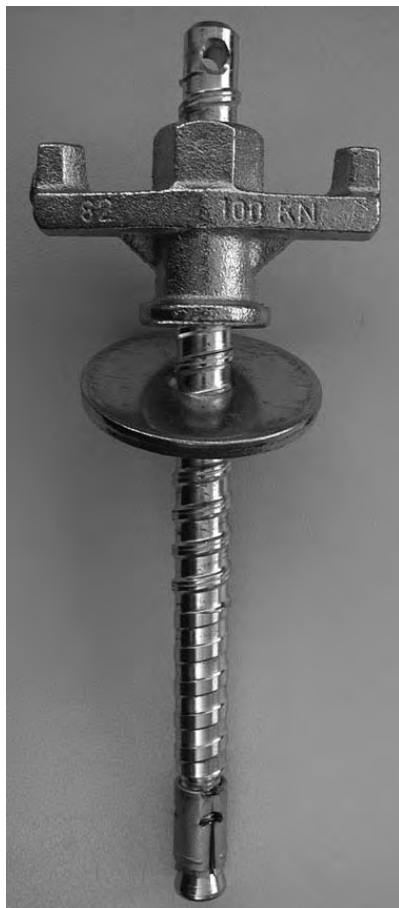
Verankerungsdübel Ø 16 mm, 210 mm lang, mit: Schlagmutter, Unterlegscheibe und 25 (verlorene) Anschraubdübel (M 12, 48 mm lang) für P-6000 Dübelfuß (Set, Bestell-Nr. 4907)
