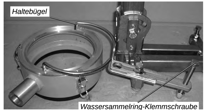
Wassersammelring mit Halter am Dübelfuß montiert Bild 3.50
