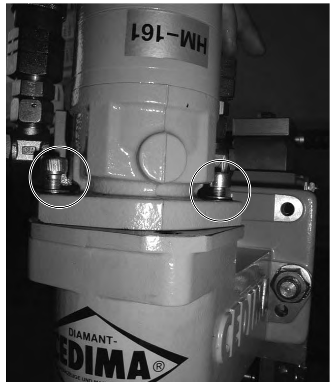
Hydraulikmotor HM-161 auf der Bohrspindel BSP-3 am P-6000 Führungsschlitten montiert
