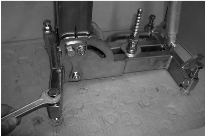
Justierschrauben (Kontermuttern) am P-6000 Stahl-Dübelfuß Bild 3.20
